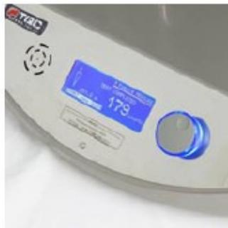
Signal visuel et acoustique pour indiquer la fin de l'essai.
