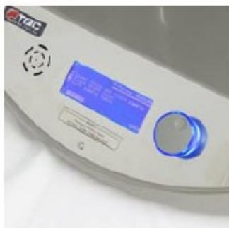
Le duromètre convient aux méthodes Persoz et König. Il suffit d'appuyer sur une touche pour changer de méthode.
