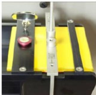
Le support d'échantillon est équipé d'un niveau à bulle. Après la mise à niveau, aucun étalonnage n'est nécessaire.
