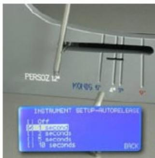
Le pendule se positionne automatiquement à l'aide d'un moteur à pas. Le pendule se libère automatiquement grâce à un système électromagnétique. Cette fonction élimine les erreurs humaines.
