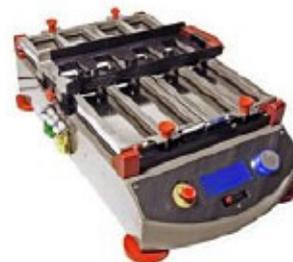
De nombreuses normes imposent de réaliser des tests d'abrasion (à sec ou humide) ou de frottement pour déterminer la qualité d'un revêtement. C'est le cas de la norme EN 13300, par exemple, qui définit des niveaux de qualité pour les revêtements intérieurs en fonction de leur résistance à l'abrasion humide.
