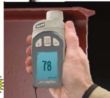
Ecran inversé pour une lecture facile lorsque le boîtier est en position inversée
