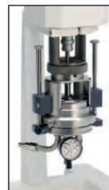
Mobile RSS-90Y pour les mesures en BU de composés de joints et autres matériaux similaires
