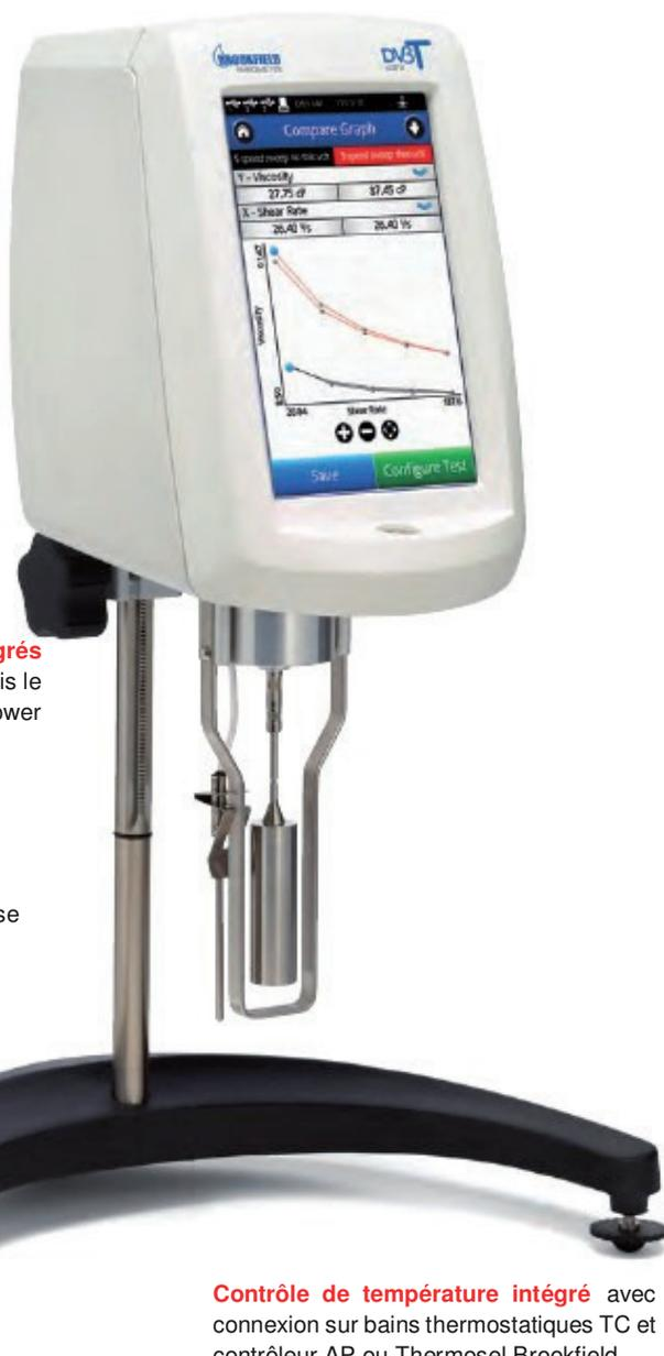
**Contrôle de température intégré** avec connexion sur bains thermostatiques TC et contrôleur AP ou Thermosel Brookfield.
